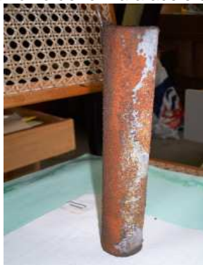
Foto 2. Detalhe da corrosão na tubulação enterrada.
