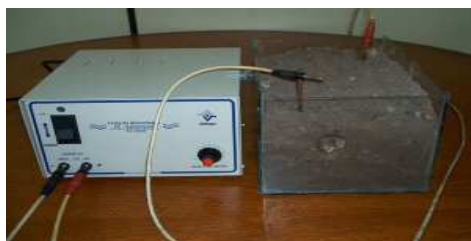
Foto 1. Conjuntos com a tubulação enterrada com o sistema de proteção catódica por corrente impressa.
