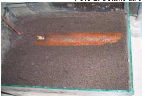
Foto 3. Estrutura sem proteção, mostrando o processo corrosivo. Foto 4. Estrutura com a proteção catódica livre da oxidação.
