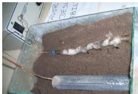
Foto 3. Estrutura sem proteção, mostrando o processo corrosivo. Foto 4. Estrutura com a proteção catódica livre da oxidação.
