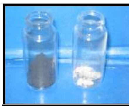
Prata impura na forma de sulfeto de prata Ag_2S (esq.) e prata calcinada Ag^0 (dir.).
